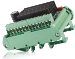
专为单推杆操作而设计。保护推杆和应用，如果超过预定的功率极限，则断开推杆电机。
